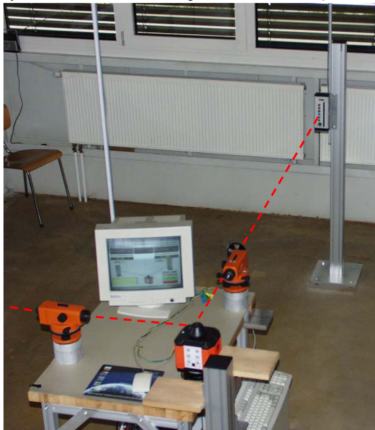
Bild 2: System zur simultanen Justage von zwei Achsen. (Messtisch mit PC und Laser)
